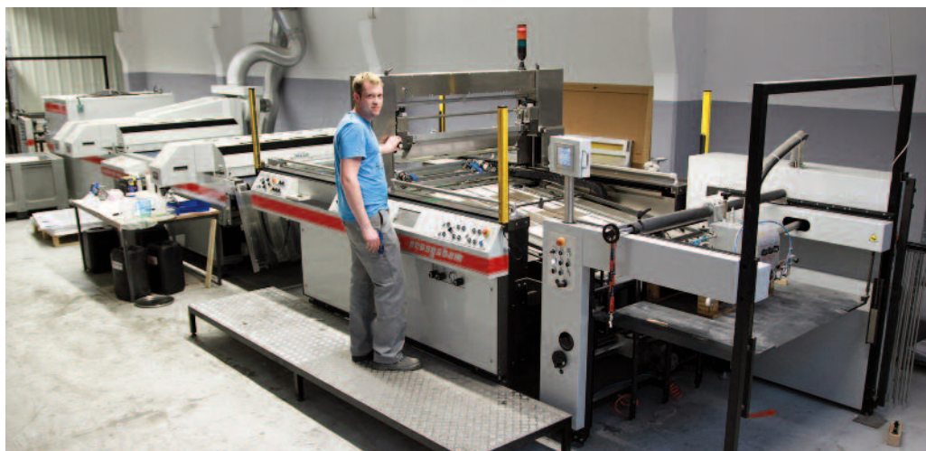
Mit einer großformatigen Siebdruckmaschine – ausgestattet mit zwei UV- und einem IR-Trockner – lackiert V4 Veredelung die unterschiedlichsten Materialien und Formate in höchster Qualität.
